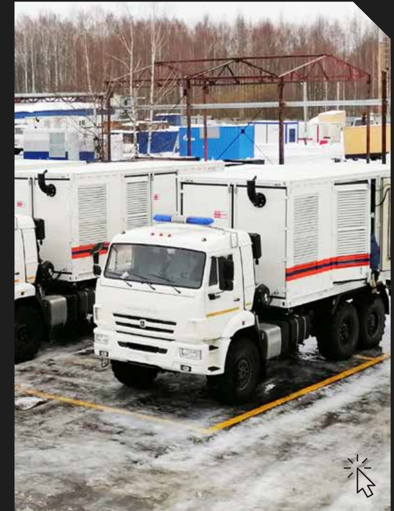
Передвижные электростанции 8,5 МВт для Московских кабельных сетей
